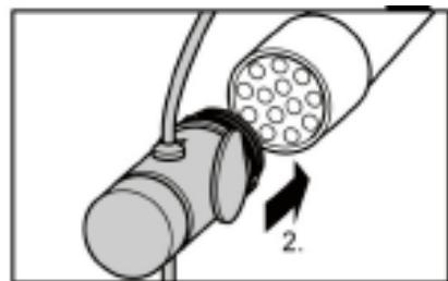
Beide stekkers zitten verwerkt in één behuizing. Over de stekker die niet gebruikt wordt, moet het bijgeleverde afdekkapje gedaan worden.
