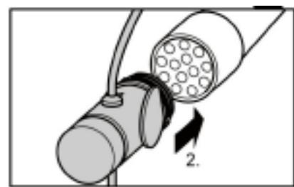
Beide Stecker befinden sich im selben Gehäuse. Auf der Steckeröffnung, die nicht benötigt wird, muss während des Betriebs die mitgelieferte Abdeckkappe angebracht werden.
